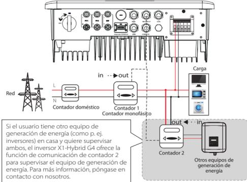
Si el usuario tiene otro equipo de generación de energía (como p. ej. inversores) en casa y quiere supervisar ambos, el inversor X1-Hybrid G4 ofrece la función de comunicación de contador 2 para supervisar el equipo de generación de energía. Para más información, póngase en contacto con nosotros.
