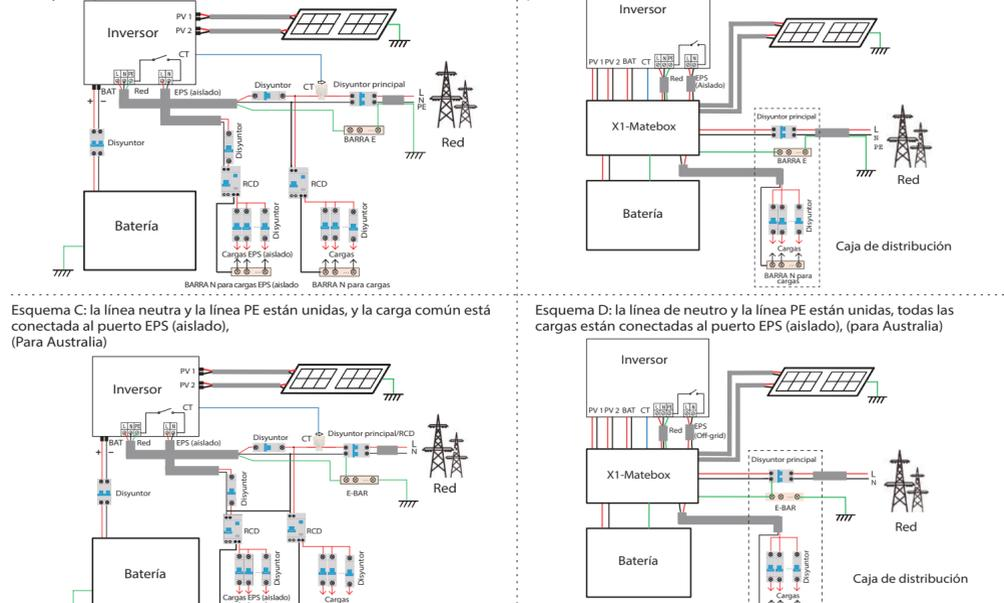
Los puertos de red y EPS (aislado) del inversor de la serie M han sido conectados, y la serie D necesita ser cableada de acuerdo con los siguientes pasos.
