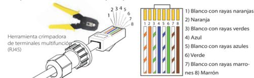
Paso 4. Apriete la línea de comunicación del BMS/contador/CT/DRM/COM/LCD completada y apriete el tapón impermeable.
