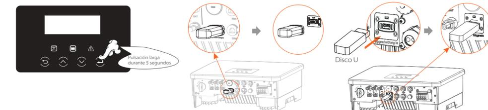
Paso 3. Operación LCD, entre en la interfaz de actualización "update", como se muestra a continuación (a); por favor, pulse las teclas arriba y abajo para seleccionar ARM, luego pulse en la página abajo para seleccionar "OK", pulse la tecla "Intro" para entrar en la interfaz de la versión del software.
