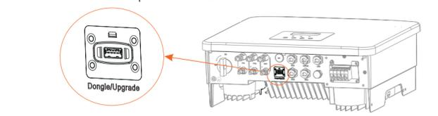
Paso 2. Conecte el dongle WiFi en el puerto DONGLE.
