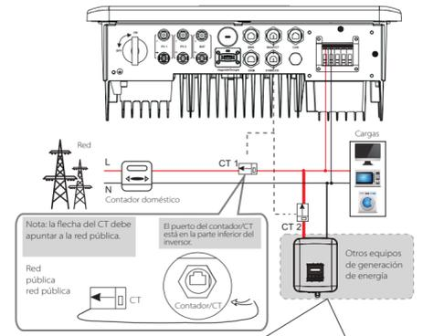
Si el usuario tiene otro equipo de generación de energía (como el inversor) en casa y quiere supervisar ambos, este inversor ofrece la función de comunicación de CT 2 para supervisar el equipo de generación de energía. Para más información, póngase en contacto con nosotros.
